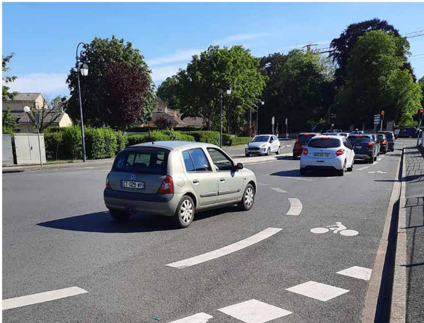
Le sas cycliste est un espace réservé aux cyclistes sur un carrefour équipé de feux tricolores. Il est placé en avant de ceux-ci et délimité par une ligne pointillée en amont de laquelle les véhicules motorisés doivent s'arrêter ; il est matérialisé par des pictogrammes vélo. Il a été officiellement intégré au code de la route en 1998 (art. R415-2 et R415-15).
