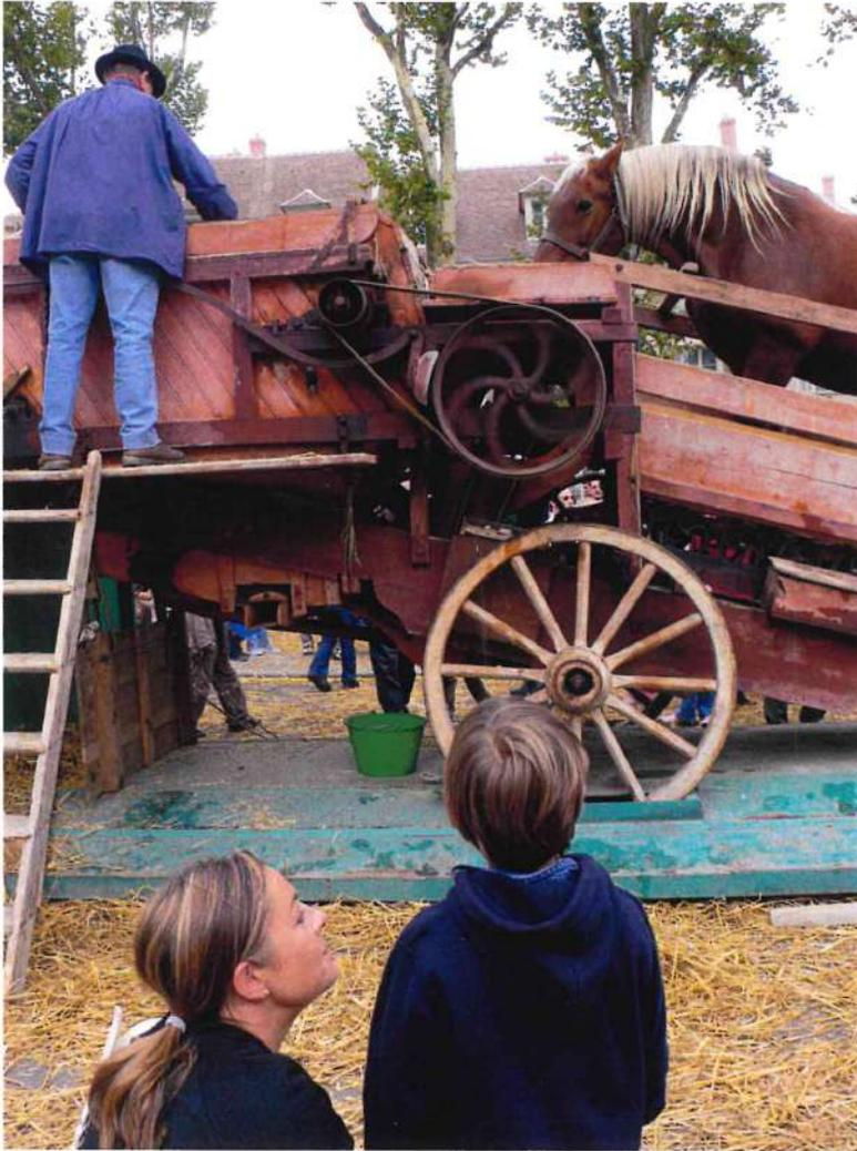
Découverte des métiers : la trépineuse, ancêtre de la moissonneuse batteuse...
